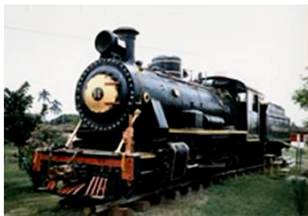
Locomotora BMAG de doce ruedas con sistema de funcionamiento con carbón.
